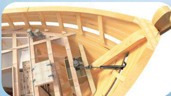
3D модель форштевня, фальшборта и якорного устройства
